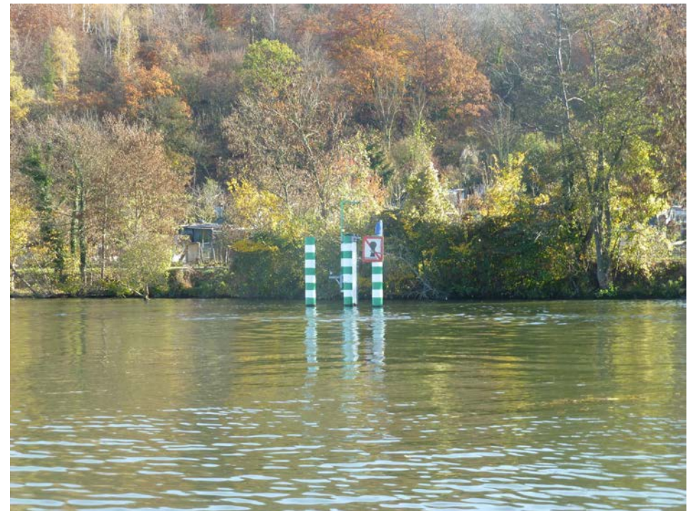
Pieux de la station débitmétrique de Creil (Oise), 14/11/18, sur lesquels se trouvent les sondes de mesure des vitesses.
