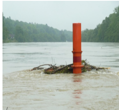
Sainte-Assise (La Seine), 02/06/16, accumulation d'embâcles empêchant la mesure de vitesse sur une des cordes de vitesse, le pic de crue n'est pas mesuré
