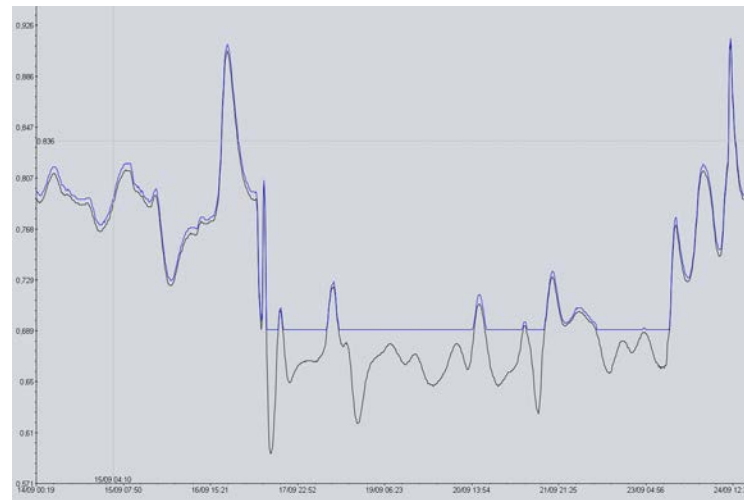
Couilly-pont-aux-dames (Grand-Morin), 09/2018- erreur de calibration du radar
